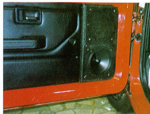
Come già detto, l'HV 1600 può essere installato in predisposizioni da 16 cm a patto che esse siano "accoglienti" nei confronti del magnete. Nella foto la portiera di una Golf 4.
