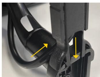
Mit dem beiliegenden Kabelkanal kann das Anschlusskabel des Monitors dezent zum Dachhimmel geführt werden.
