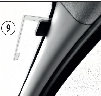
Installer l'antenne DAB+ sur la partie droite du pare-brise avec la partie couleur bronze en contact avec la carrosserie du véhicule (fondamental pour l'alimentation de l'antenne).
