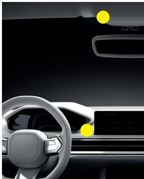
Suchen Sie die Position im Fahrzeuginnenraum für den Einbau des Mikrofons (7) so aus, dass es so nah wie möglich und zum Fahrer hin ausgerichtet ist, um seine Leistung zu optimieren. Befestigen Sie die Halterung mit doppelseitigem 3M-Klebeband.
