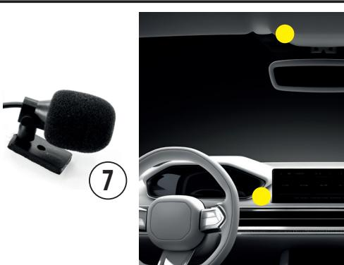
Choisir l'emplacement dans l'habitacle pour installer le microphone (7) de manière à ce qu'il soit le plus proche possible et face au conducteur pour une utilisation optimale..
