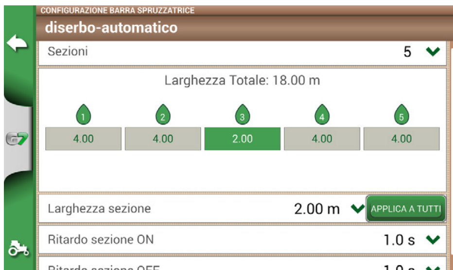
Figura 4.9.j Configurazione dei ritardi di apertura e chiusura della sezione
