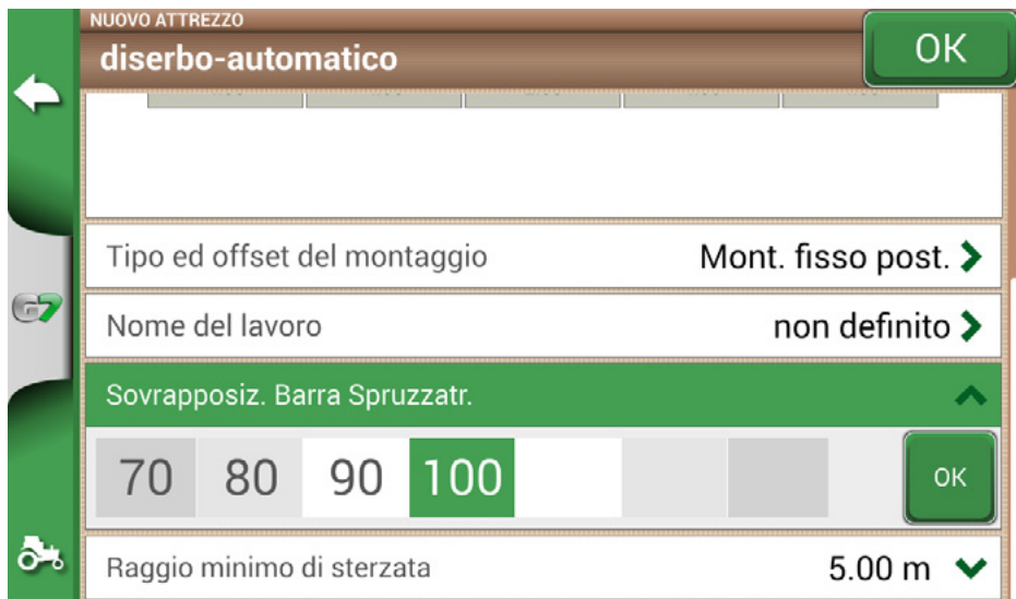
Figura 4.9.k Configurazione della percentuale di sovrapposizione
