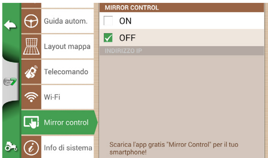
Figura 2.4.k Pagina di configurazione del Mirror Control
