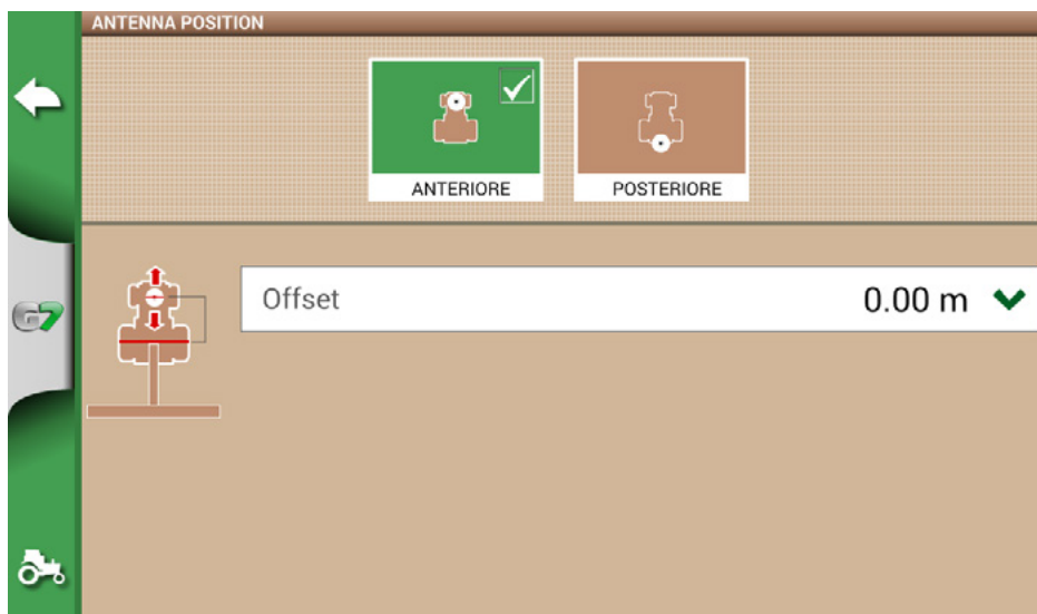
Figura 2.4.d Pagina di configurazione dell'antenna rispetto all'asse posteriore del trattore
