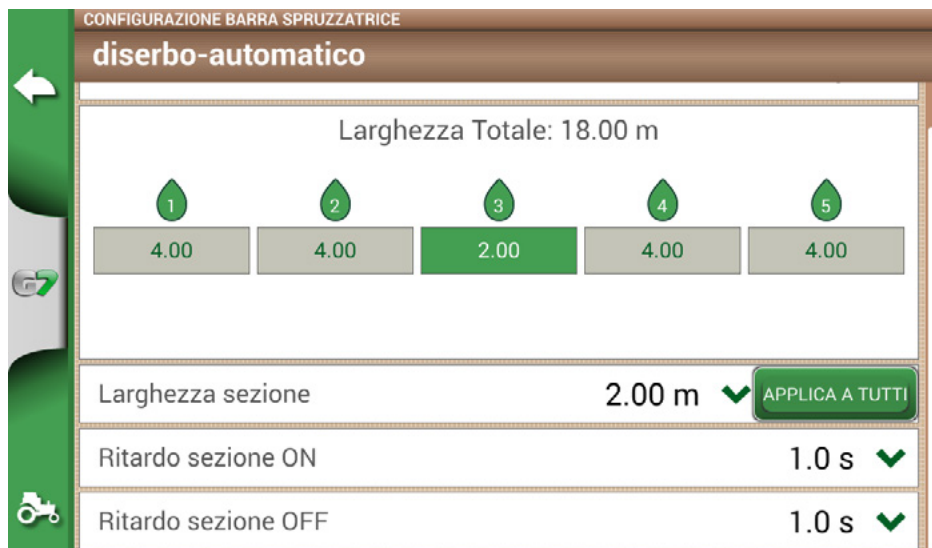
Figura 4.9.i Esempio di una barra da 18 m con 5 sezioni
