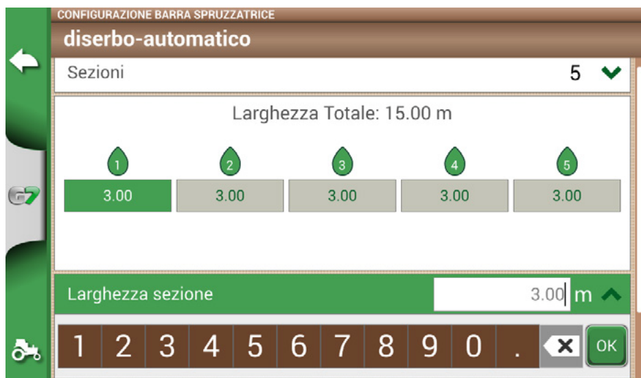
Figura 4.9.h Configurazione della larghezza della singola sezione
