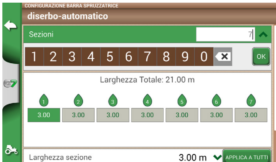
Figura 4.9.g Configurazione del numero di sezioni
