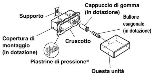
\* Se la copertura di montaggio sembra allentata nel cruscotto, piegare leggermente le piastrine di pressione per risolvere il problema.
