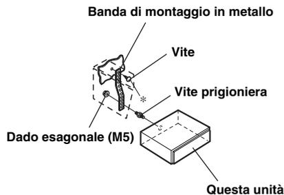
Se il veicolo è dotato di staffa, montare il bullone esagonale lungo sul pannello posteriore dell'unità CDE-9880R/CDE-9882Ri e applicare il cappuccio di gomma sul bullone esagonale. Se il veicolo non è dotato del supporto di montaggio, rinforzare l'unità principale con la banda di montaggio in metallo (non in dotazione). Collegare tutti i cavi dell'unità CDE-9880R/CDE-9882Ri secondo le istruzioni dettagliate riportate nella sezione Collegamenti.
