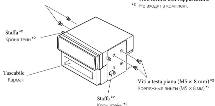
**Nota:** Durante l'installazione dell'apparecchio sulla staffa di montaggio, utilizzare esclusivamente le viti da 8 mm. Si ricorda che l'uso di viti più lunghe potrebbe danneggiare l'apparecchio.
