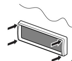
Inserire l'unità nel supporto di montaggio premendo sui quattro angoli della finitura della piastra.
